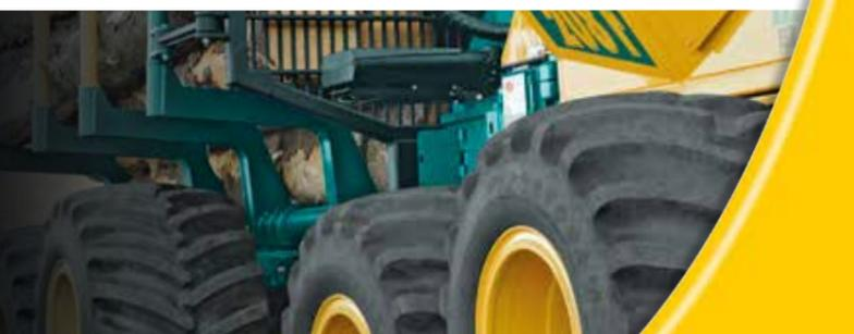
Von Anfang an setzte HSM bei der Harvesterreihe 405H auf das mittlerweile im Markt etablierte 8WD Konzept. Niedrig aufgebaute Kran, die starke Verwindungssperre, tief eingebauter Motor und Dieseltank sorgen für beste Standfestigkeit. Ein weiteres Merkmal ist der große Lenkwinkel von 50°, der eine Wendigkeit gewährleistet, die oft größer ist als bei vergleichbaren 6WD Maschinen.
