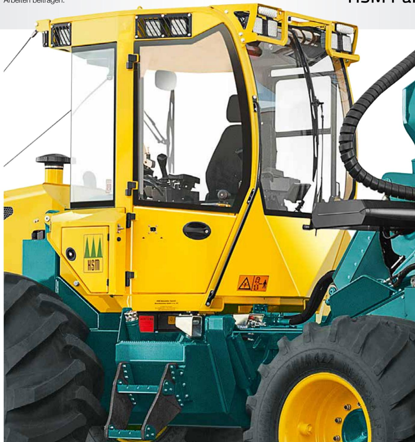
Elektrisch drehbarer **Fahrerstand**
